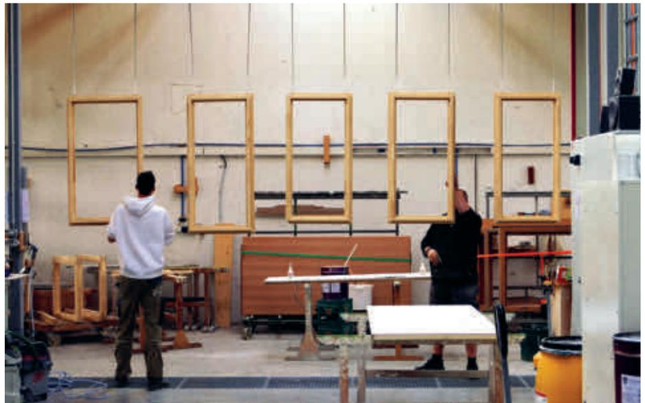
Nur das Auf- und Abhängen der einzelnen Elemente sowie der Zwischenschliff erfolgen noch händisch.
