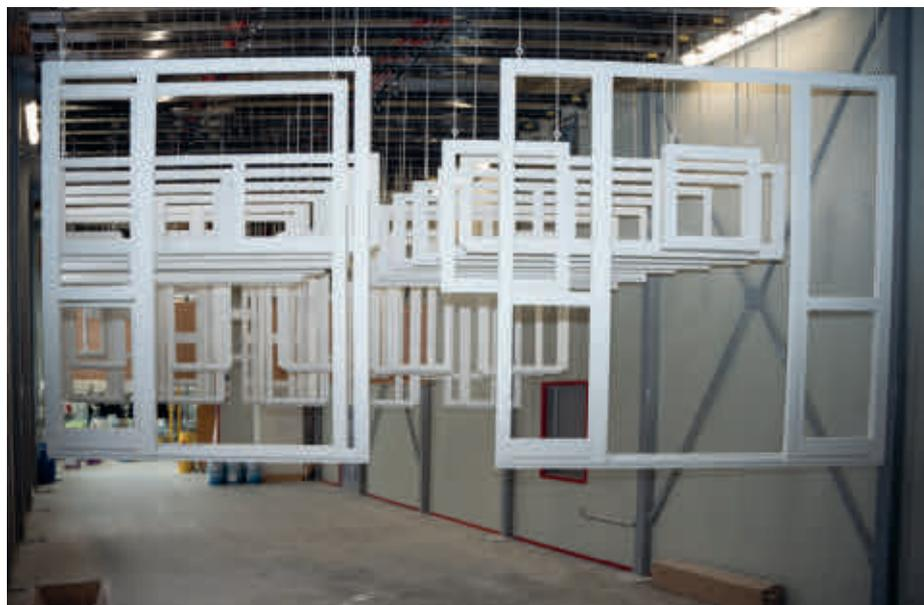
*Nach der Lackierung werden die Elemente durch einen Kondensationstrockner mit zusätzlichem Umluft-System geführt.*
