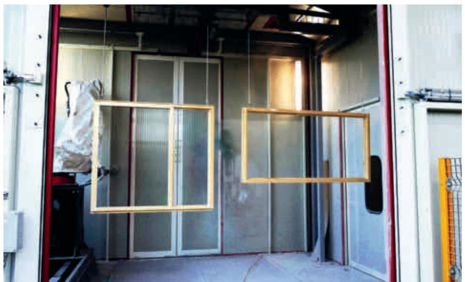
Die vorbereiteten Elemente werden gescannt und fahren anschließend automatisch in die abgeschlossene Lackierkabine.
