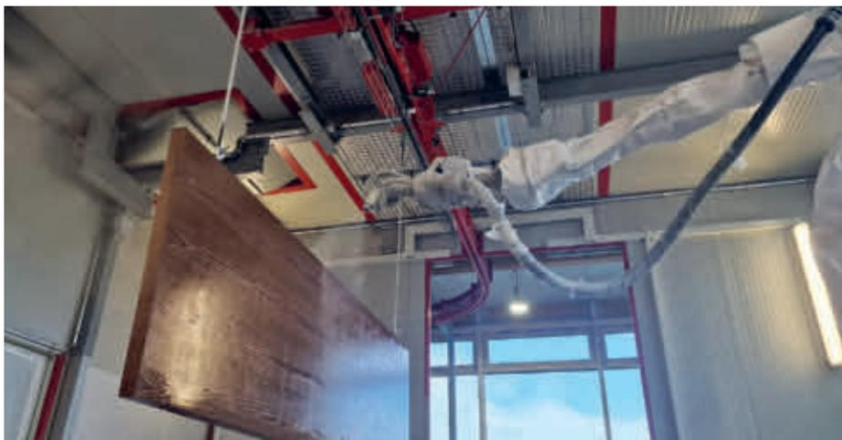
*Dank des Einsatzes eines Spritzroboters kann eine gleichbleibende Schichtdicke der Lackierung und eine hohe Oberflächenqualität gewährleistet werden.*
